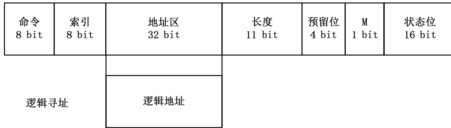
EtherCAT 逻辑寻址结构
